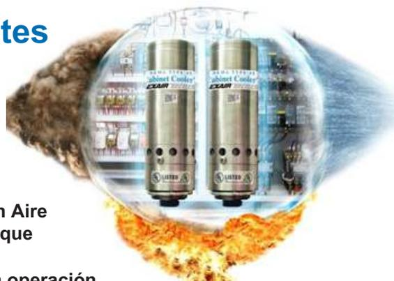
Los Refrigeradores de Tableros EXAIR utilizan Aire Comprimido para generar un flujo de aire frío que disipan el calor en gabinetes eléctricos. Su tecnología sin partes móviles, asegura una operación confiable, libre de mantenimiento y de respuesta instantánea. Aptos para entornos industriales severos, ofrecen una alternativa limpia y siendo de rápida y sencillo instalaciones.
