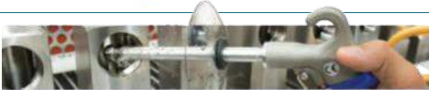
La pistola de Contrasoplado modelo 1206SS-6-CS elimina virutas desde el interior de una pieza mecanizada
