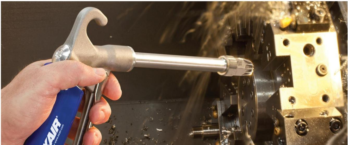
Una Pistola de Soplado de Mango Suave modelo 1210-12 sopla refrigerante y viruta de metal de las mordazas de la torreta de un torno CNC
