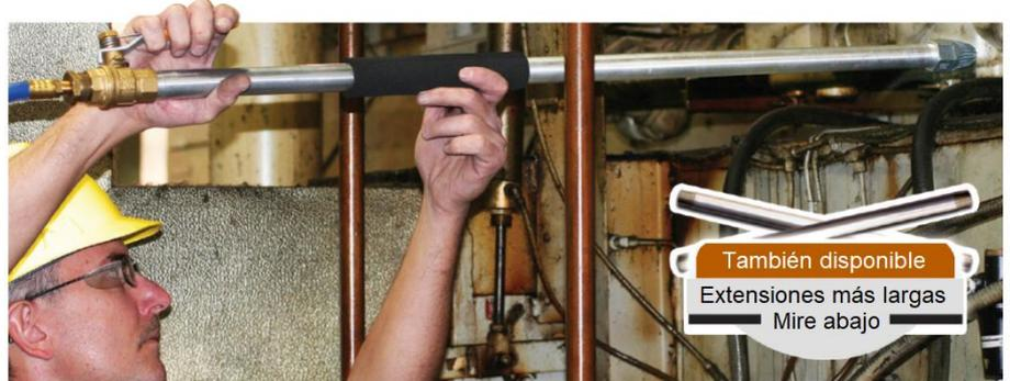
La extensión de 3' en la Pistola de Soplado Súper Blast modelo 1215-3 ayuda a un operario a proveer la máxima fuerza de soplado a áreas remotas, ajustadas o de difícil acceso.
