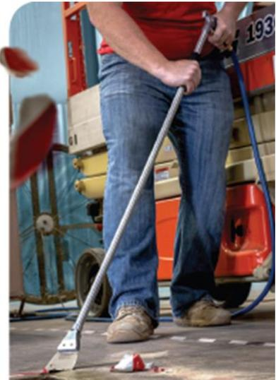
El modelo 1244-36 raspa y sopla una vieja cinta del piso de concreto.
