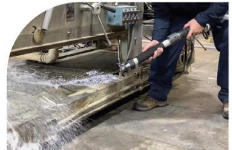
El La Pistola de Soplado de Seguridad TurboBlast sopla restos / retazos de corte de papel.
