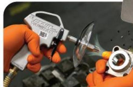
El modelo 1699-CS elimina virutas y refrigerante de una pieza mecanizada.
