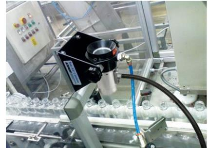
El cañón de aire Ionizado Gen4 modelo 8292 elimina la estática y el polvo previo a proceso de llenado de botellas.
