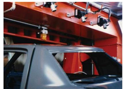
Tres (3) Cañones de Aire Ionizado Gen4 soplan los contaminantes de las carrocerías de los autos previos al proceso de pintura.
