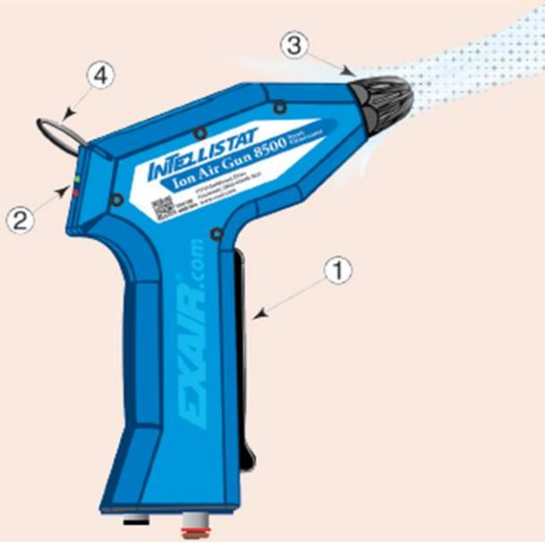
Al presionar el gatillo de recorrido corto de dedo completo (1) se activan los iones eliminadores de estática y el flujo de aire. El funcionamiento correcto o incorrecto se indica mediante un LED verde o rojo (2). La boquilla (3), que no daña superficies, proporciona un funcionamiento silencioso y cumple con las normas OSHA. Se incluye un gancho (4) para mantener el Intellistat convenientemente almacenado.
