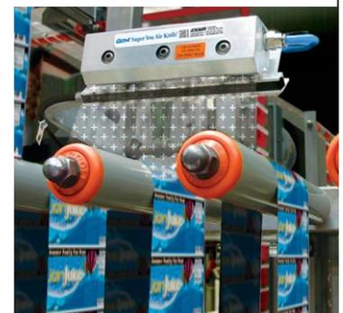
La Súper Cuchilla de Aire Ionizado Gen4 elimina la carga estática en las etiquetas que se aplican a botellas de PET para bebidas gaseosas.
