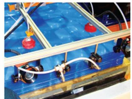
Los Cañones de Aire Ionizado Gen4 modelo 8192 proveen eliminación de estática entre los lentes de paneles solares para asistir la separación de los mismos durante la producción.
