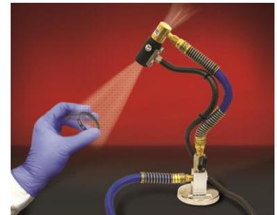
El Kit de Jet de Aire Ionizado con la base modelo 8194-9362 limpia el polvo de unos lentes de vidrio previo al proceso de instalación en un medidor.
