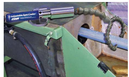
Una manguera de PVC es enfriada a la salida de una extrusora de modo que pueda ser enrollada de forma inmediata
