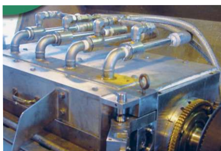
Enfriamiento de una cuchilla en una pelletizadora para prevenir formas irregulares
