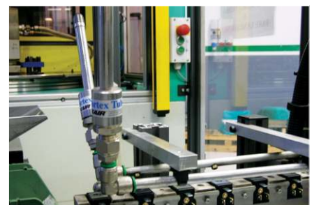
2 Tubos Vortex medianos refrigeran una bobina solenoide luego de una operación de soldadura
