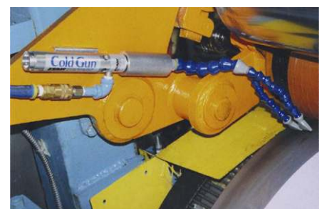
Una Pistola enfría un rodillo a una temperatura de -7°C evitando el abultamiento y el atascamiento en operaciones de enrollado
