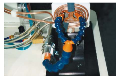
Enfriamiento de piezas en un molde de inyección con un Vortex.
