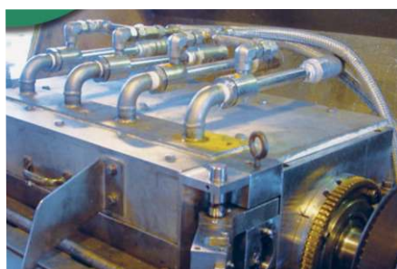
Enfriamiento de una cuchilla en una pelotizadora para prevenir formas irregulares
