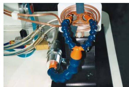
Enfriamiento de piezas en un molde de inyección con un Vortex.
