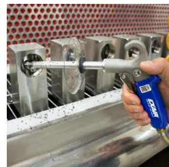
Pistola con Boquilla de Contra Soplado y Protección de Seguridad sopla virutas de un diámetro interior
