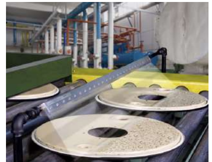
Una Súper Cuchilla seca tapas de tambores luego del proceso de lavado
